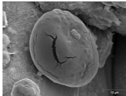
Figura 10 - Estrutura mostrando fenda de expansão causada pela emissão do feixe de elétrons do MEV
